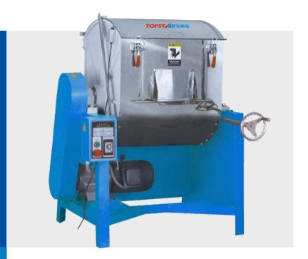
卧式桨叶,叶片采用加厚不锈钢制作,与桶壁距离精密计算,拌料迅速、均匀。配用摆线针轮减速电机,噪音低,持久耐用。料桶可倾斜100°,方便卸料。
